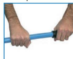
**2. BISELAR:** Las posibles rebabas producidas en el corte deben eliminarse, biselando la parte exterior del tubo.
